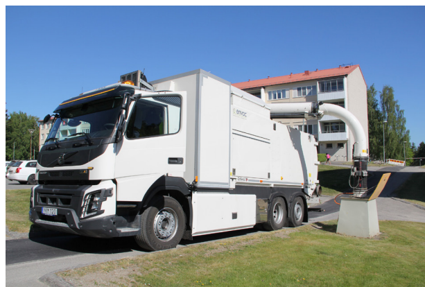
Figur 7 Mobil sopsug som är ansluten till dockningspunkt.
