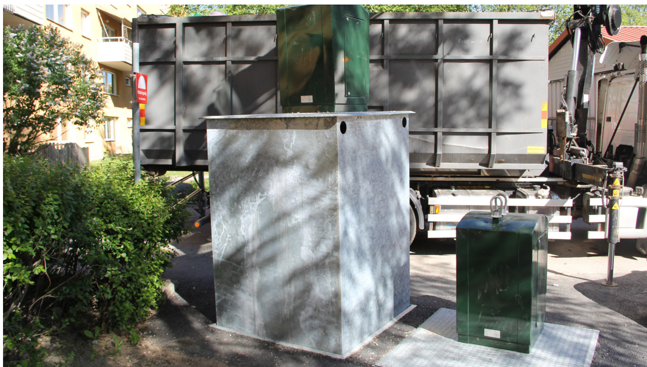
Figur 20 Tömning av botten tömmande behållare under jord.
