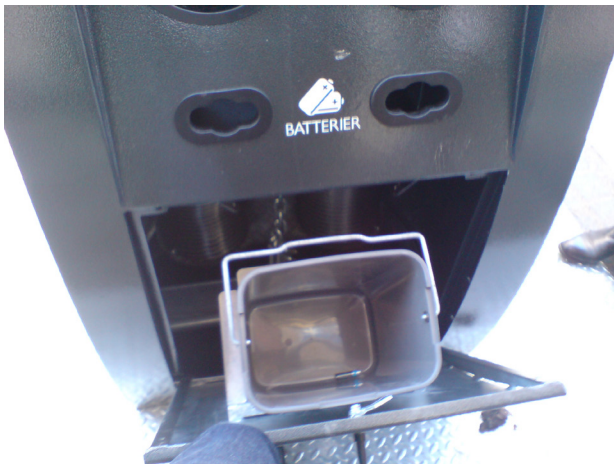
Figur 6 Bottentömmd behållare utrustad med behållare för batterier och glödlampor.
